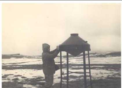
Крым, Ай-Петри. Сборка осадкомера ОСК-2. 1957 г.
