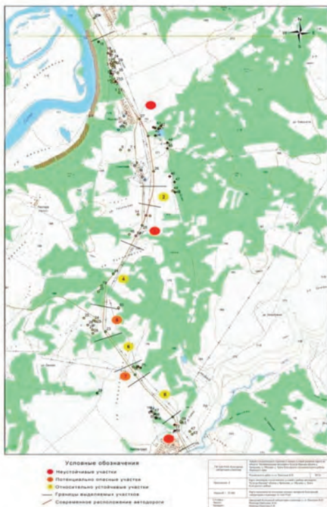
Рис. 3. Карта инженерно-геологических условий в районе автодороги с. Зуята-Заспалово.
