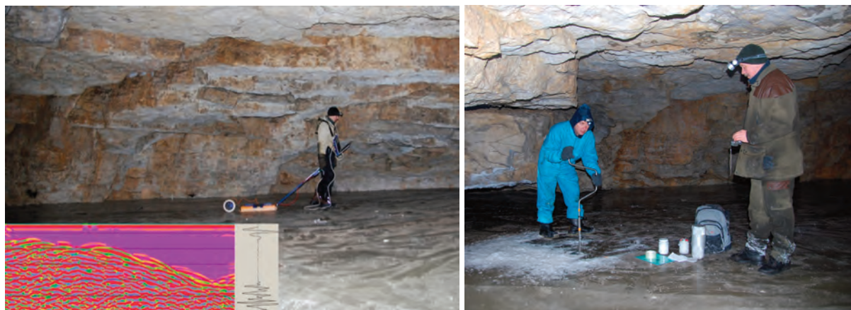
Рис. 1. Георадарные исследования и заверочное бурение
