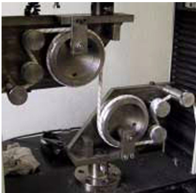
Рис.34. Фото 60 из «Отчета», стр.113: Кабестанное устройство, используемое для испытаний образцов веревок ( Capstan arrangement used to break rope samples ).
