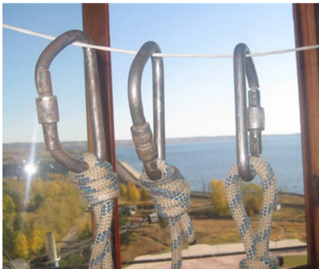
Рис.39 Добавление 1 и 2 оборотов веревки в «бочонке» делает его несравненно более устойчивым к развязыванию. Тема «Усы самостраховки: конфигурации, способы вязки, энергоёмкость», автор фото: ник Авальман ( http://www.promalp.ru/viewtopic.php?f=13&t=26025 ) от 27 сен 2010 года:
