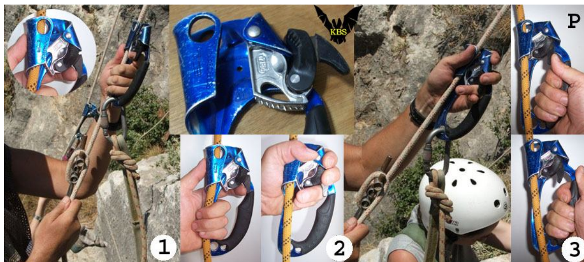
Рис. 3. Самостраховочный эксцентриковый зажим "Reflex-ExS" на основе пуани Петцля.
