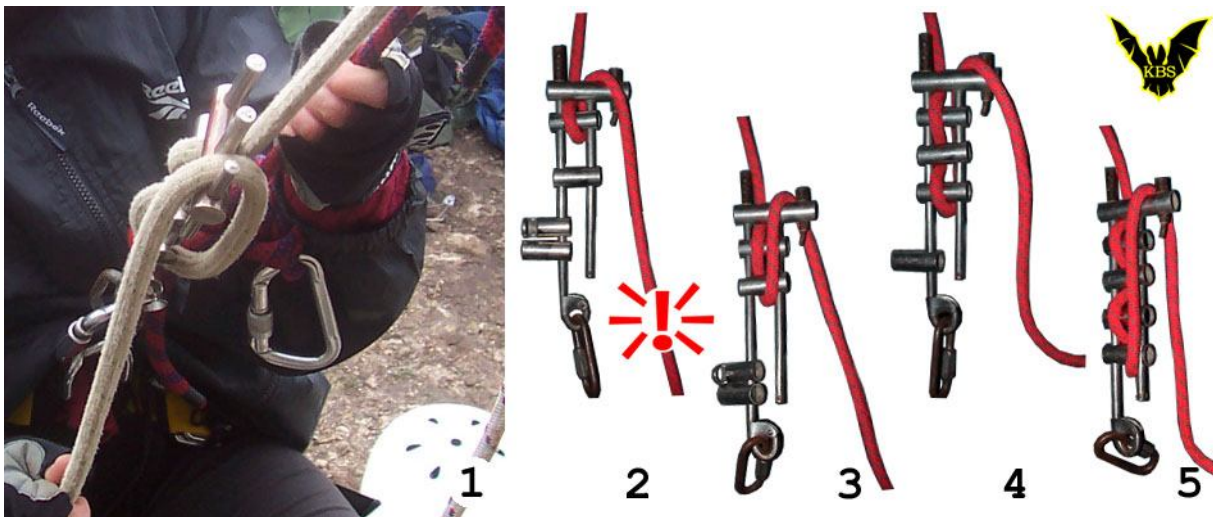
Рис. 5. Основные ступени торможения "Азиан-рэк" с использованием гипер-бар:
