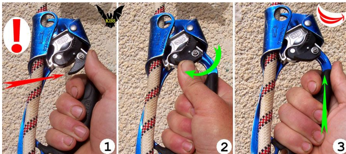
Рис.13. Превращение "Пуани-Рефлекс" в зажим для подъема (ascender) происходит буквально одним движением пальца:
