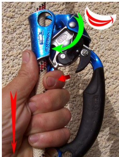
Рис.12. Срабатывание зажима, оснащенного курком "Рефлекс" под действием панического хватательного рефлекса в момент утраты контроля над спуском.
