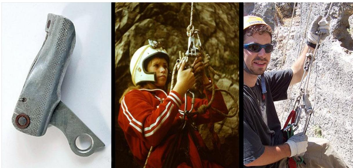
**Рис.56.** Первый в мире специальный зажим для самостраховки при спуске – «Shunt» Фернó Петцля:
