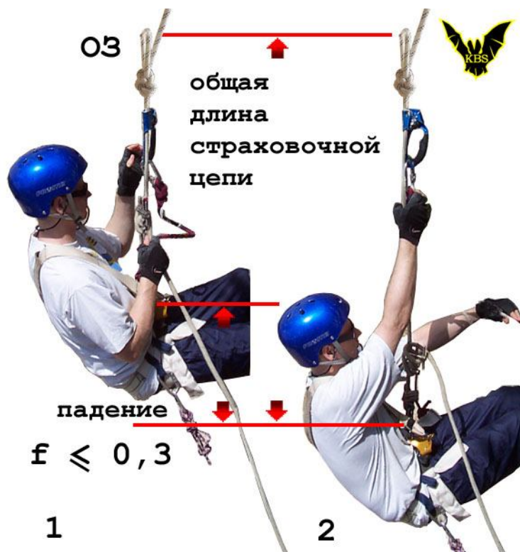
Рис. 9. Сразу под узлом основного закрепления фактор возможного падения уже снижается до 0,3:
