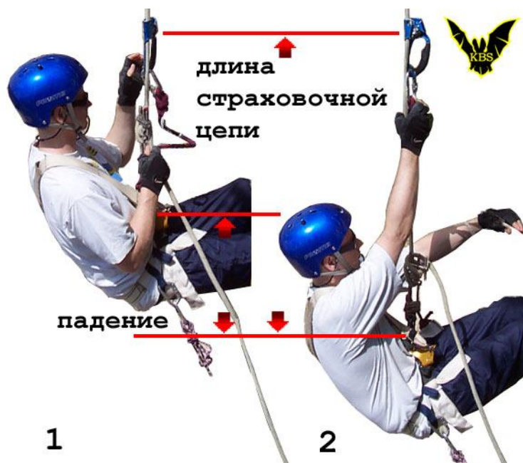
Рис. 8. Фактор падения при потере контроля над спуском при условии мгновенного схватывания зажима самостраховки всегда значительно меньше 1.0:
