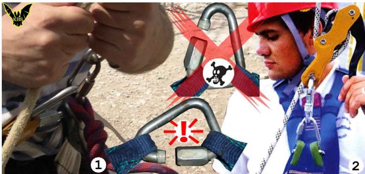
**Рис.18.** Положение беседочного МР "Дельта" влияет на безопасность подвески:
