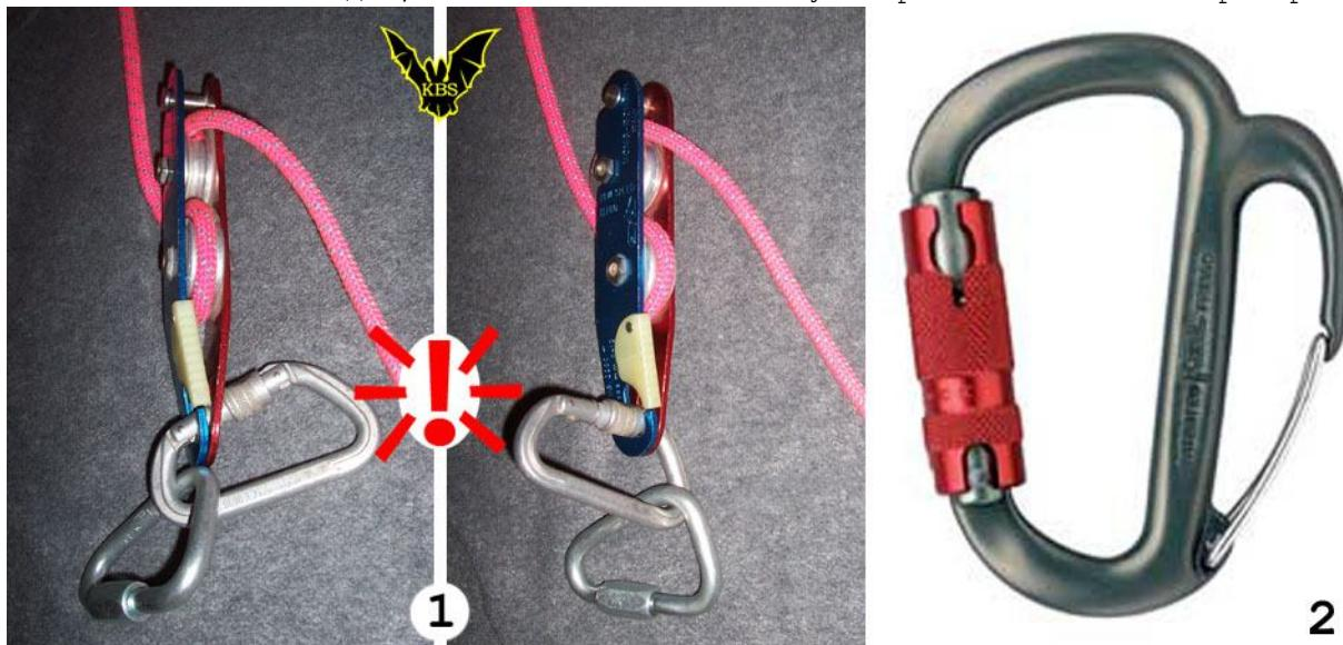
**Рис.20. Карабин в качестве коннектора ФСУ.**
