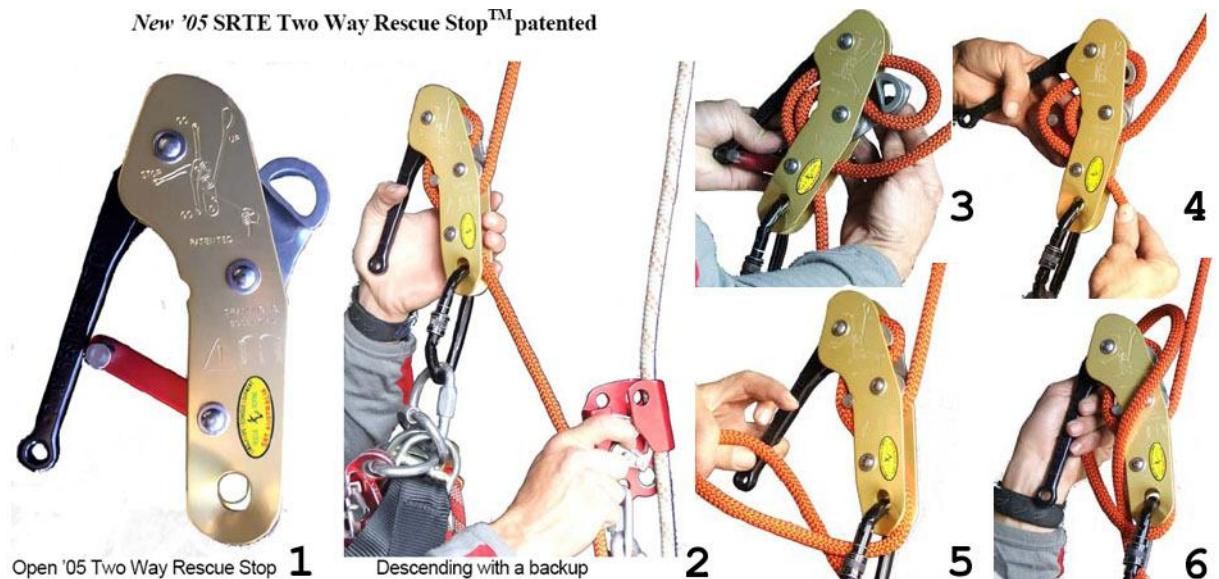
**Рис.25. Австралийский двойной спуск "05 Two Way Rescue Stop TM" фирмы "SRTE":**
