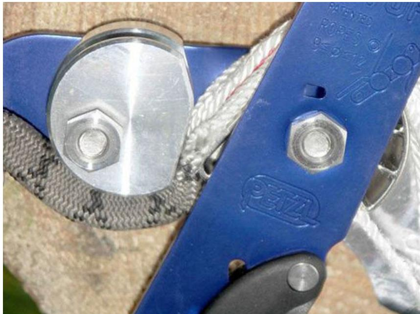
Рис. 26. Аналогичные результаты получены Владом Еремеевым в Москве в 2006 году - "Petzl Stop" при падении груза 90 кГ (у британцев груз был 100 кГ) с фактором 1,0 снимает оплетку веревки, сплавляя волокна в месте остановки.
