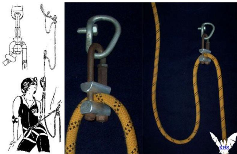
**Рис. 94** Карабин-амортизатор Серафимова (иллюстрация из моей работы "Автоматическая страховка в горах и пещерах")
