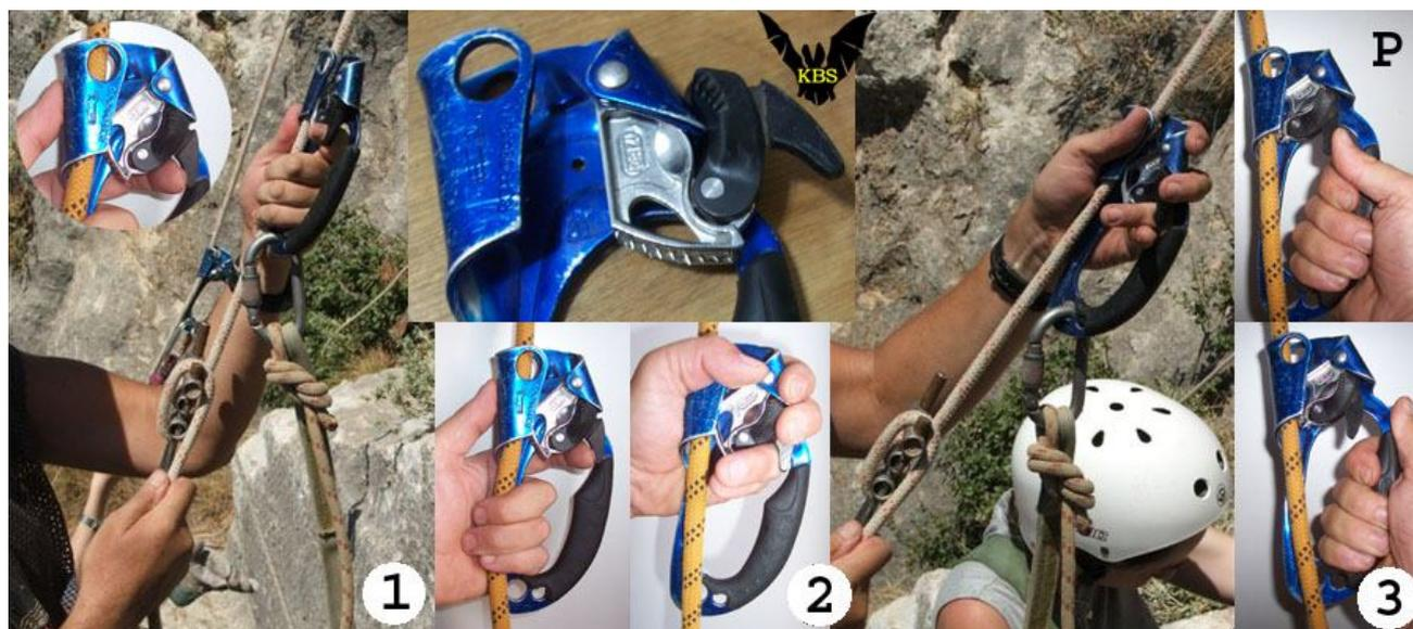
**Рис. 90** Самостраховочный эксцентриковый зажим "Reflex-ExS" на основе пуани Петцля. 1 - ведение указательным пальцем. 2 - ведение безымянным пальцем. 3 - возможность воздействия на рычажок "Рефлекса" большим пальцем при подъеме
