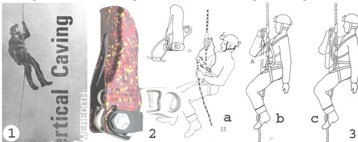
**Рис. 43** Зажим "Shunt" и иллюстрации к его использованию в книге "Vertical Caving", Майка Мередита (Mike Meredith), 1979 год. 1 - копия обложки с фотоотпечатков, дошедших до СССР. 2 - зажим "Shunt" фирмы "Petzl", каким его можно было купить в 2005 году. 3 - иллюстрации из книги: а - самостраховка "Шантом" при спуске, б - подстраховка "Шанта" от проскальзывания зажимом и с - схватывающим узлом при подъеме.
