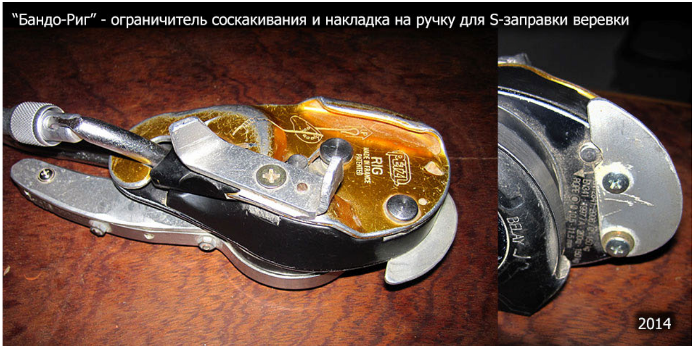
Рис.32. Дюралевая накладка на ручку и ограничитель сползания верёвки в её сторону я сделал где-то в июне 2014 года – важные усовершенствования с точки зрения использования «Бандо-Рига» в спелеотехнике.
