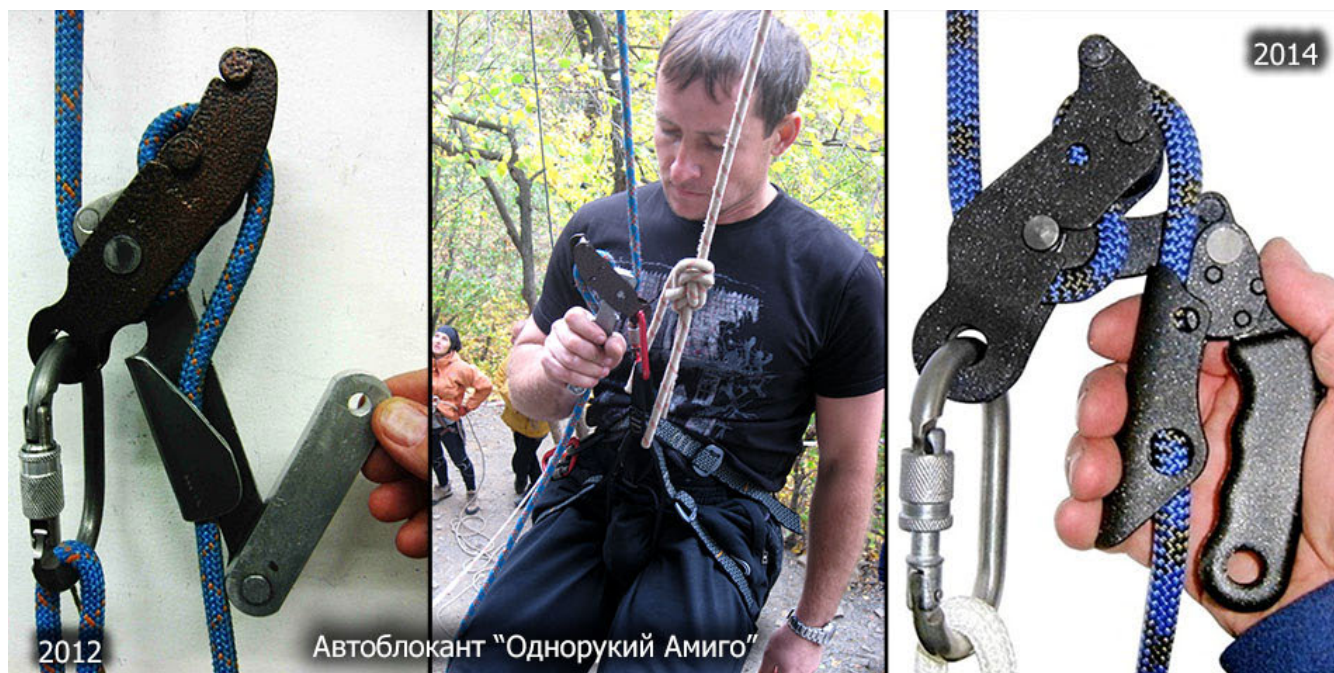
Рис.34. Автоблокант «Однорукий Амиго», разработанный А.Костромитиновым, Украина: слева – один из первых вариантов на базе «Стопор Десантёра», август 2012 года; в середине – первые испытания 14 октября 2012 года на Кубке Памяти в п.Зуевка Донецкой области, Украина; справа – конечный вариант на основе «Десантёра "БлэкДжэк"», поступивший в продажу в феврале 2014 года.
