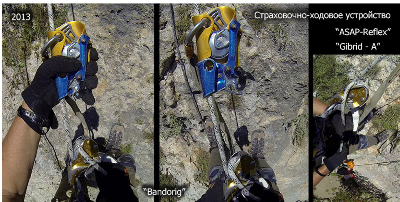
Рис.38. Первые скальные испытания «Гибрида – А» в сочетании с одноручным автоблокиратором «Бандо-Риг» 28 марта 2013 года: слева – активная самостраховка курком «Рефлекс», управление «Бандо-Ригом» одной рукой; середина – пассивная самостраховка центробежным тормозом, кулачок открыт; справа – спуск на «Бандо-Риге» с обеими руками на входящей ветви верёвки очень надёжен и удобен при транспортировке тяжёлого груза, например, пострадавшего (самостраховка «Гибридом» в мобильном положении: кулачок отключен).
