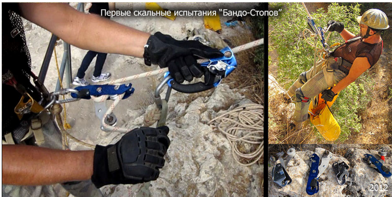
Рис.24. Первые практические испытания «бандостопов» на скалах 24 августа 2012 года (справа внизу новое снаряжение, испытанное: «Грэй», «Бандо-Стоп» со специальной ручкой, «Бэйсик Рефлекс» и «Краснорукий Бандо-Стоп» с роликом на перелицованной оригинальной ручке).
