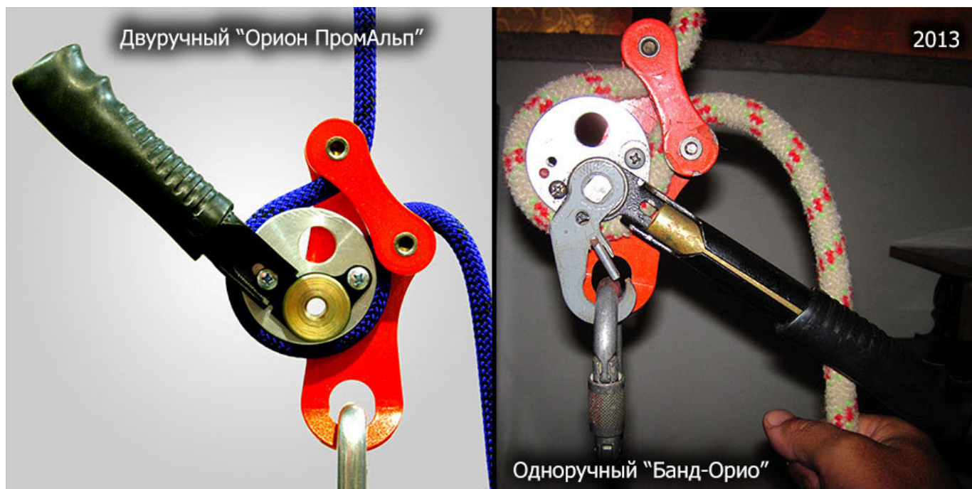
Рис.33. Одноручный «Бандо-Рио» получается из двухручного автоблоканта «Орион Пром-Альп» простым поворотом рукоятки, 2013 год.
