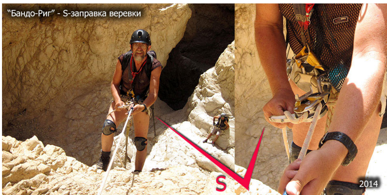
Рис.31. Испытания «Бандо-Рига» с S-положением верёвки в каньоне Рахаф, 2 мая 2014 года.
