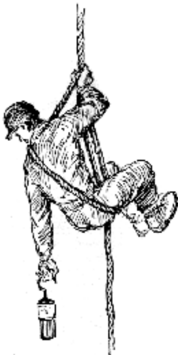
Спуск по одиночной веревке при помощи «сидячей» петли (см. рис.)
