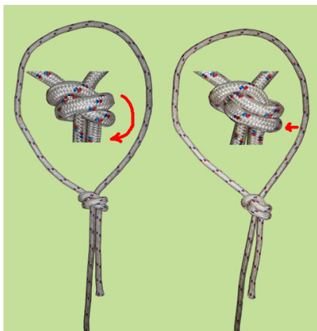
Рис.19. Удавка «британского Баррела» при навешивании на объемную опору. Показанного изменения положения петель в «бочонке» при затягивании петли не происходит, это можно сделать специально, чтобы убрать ненужный косметический перехлест витков в узле. Кстати, если уж и навешивать такой петлей, то не с одним шлагом (оборотом вокруг опоры), как на рисунке, а минимум с двумя.
