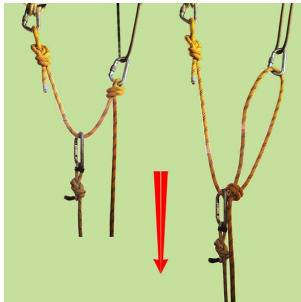
Рис.18. Деформация скользящей петли на основном закреплении при нагрузке карабином уса участка, соединяющего основное и дублирующее закрепления.
