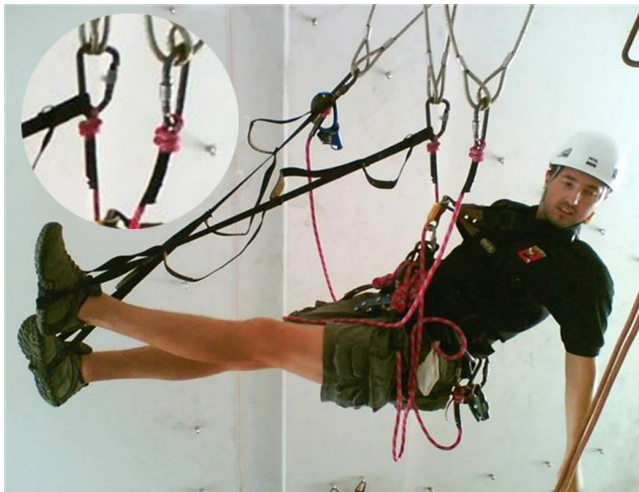
Рис.25. Обматывание кончиков изолянтной лентой лишает их гибкости и препятствует самопроизвольному развязыванию «бочонка», фото из Темы «Усы самостраховки: конфигурации, способы вязки, энергоёмкость»
