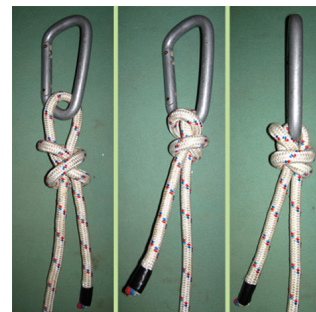
Рис.27. Результат приложения нагрузки к усю с полностью незатянутым «бочонком». Забравшийся вверх участок 4-4 (согласно Рис.21) напрямую связан с выходящим из «бочонка» кончиком 5-5. И его прижимает сейчас только затянувшийся виток 3-3. Это значит, что внутреннего трения в «бочонке» меньше, чем в правильно сформированном изначально.
