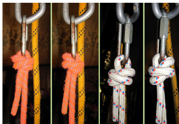
Рис.20. Поведение «британского Баррела» при затягивании весом человека на мэйлон рапиде «GO» диаметром 7 мм. Ни о каком «втягивании карабина» или «натягивании бочонка» речи не идет, а до свободного кончика нагрузка через «бочонок» просто не доходит.
