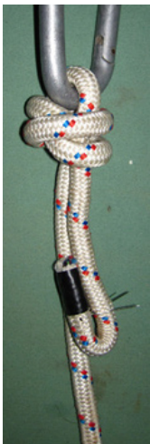
Рис.26. Я сколол булавками выходящий из «бочонка» кончик так, как сшил бы его, создавая «стопорную шивку». Кстати, тянуть за такую шивку, затягивая «бочонок», весьма удобно.
